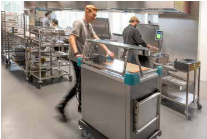
Der Multiserv-Wagen von Socamel ermöglicht die sichere Kühlung, Regeneration und Ausgabe von Speisen in einem Gerät – flexibel einsetzbar in Cook-Serve-, Cook-Chill- und Cook-Freeze-Systemen.
